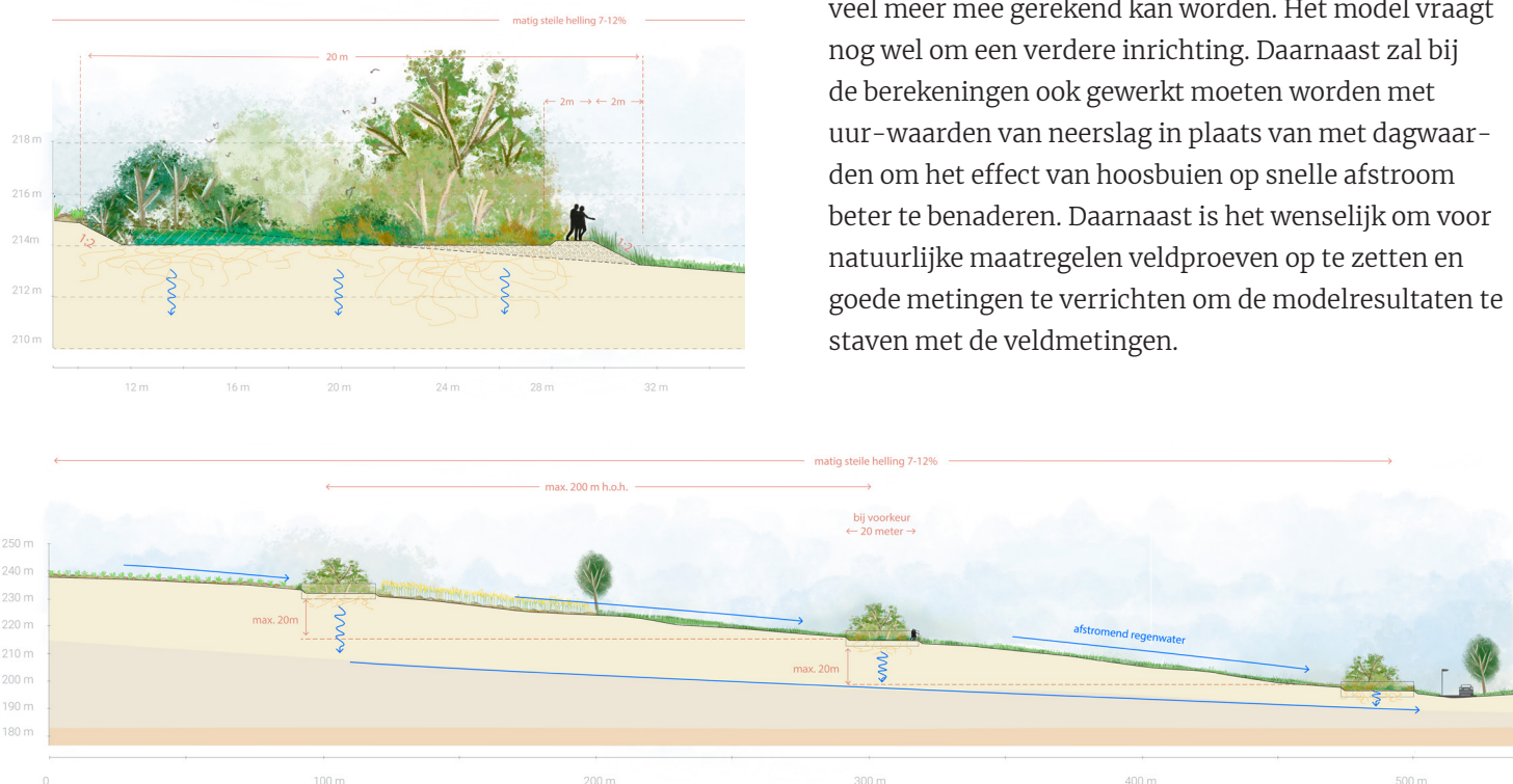
Doorsneden bij maatregel 3, infiltratiestroken op een matig steile helling.
